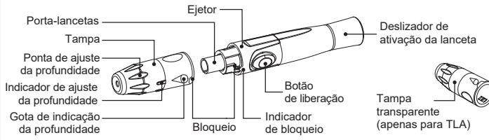
O dispositivo de punção oferece 6 níveis de profundidade de penetração na pele:
