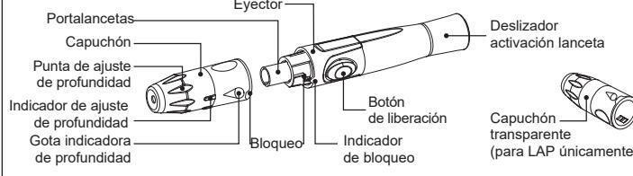
El dispositivo de punción le ofrece 6 niveles de profundidad de penetración en la piel:
